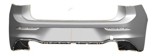
Abdeckung vorn Basis VW380 PA gespritzt auf einer KM 4000  Abdeckung hinten Basis VW380 PA gespritzt auf einer KM 2700/KM 4000
